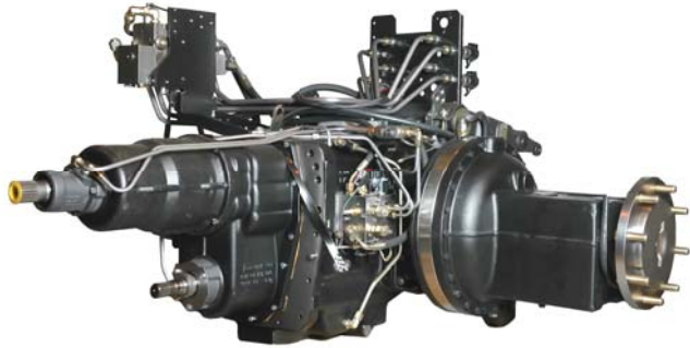
Трансмиссия фирмы Valtra (Финляндия) с трехступенчатым переключением передач под нагрузкой (36 скоростей вперед/36 скоростей назад)
