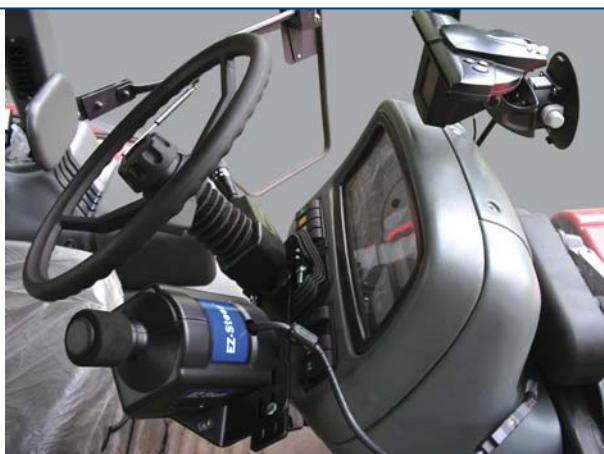
Система GPS и автоматическое подруливающее устройство, устанавливаемое на трактор (опция).
