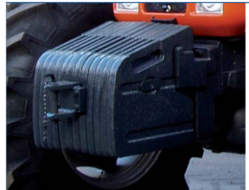
В базовой комплектации трактор комплектуется съемными балластными грузами.
